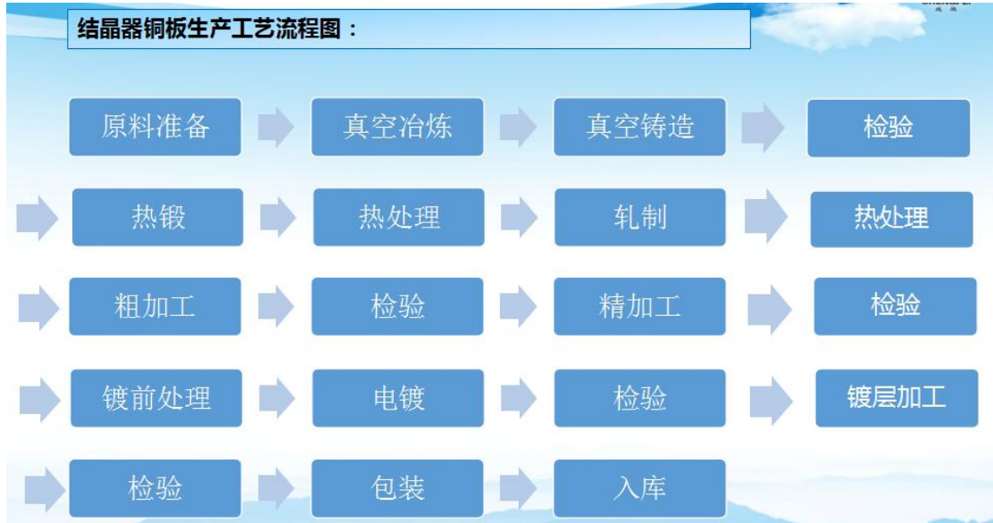
图3-2 结晶器铜板生产工艺流程图
